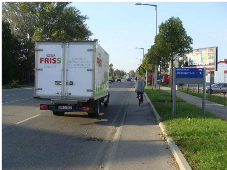
94. ábra Megemelt kerékpársáv „K” szegéllyel és az úttesten kijelölt sárga burkolati elválasztással (Szeged, teljes szélesség: 1,30 m a „K” szegélyig) Forrás: Google
