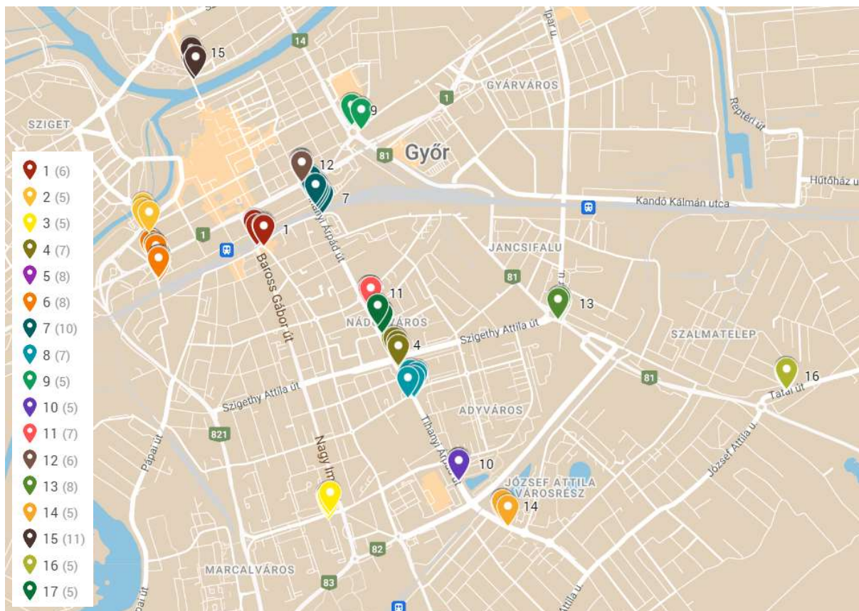
46. ábra: A Győrben azonosított 17 kerékpáros balesethalmozódási hely (a zárójelben lévő értékek az egyes góchelyekhez tartozó balesetszámokat mutatják)
