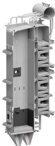
39. ábra Buborékos fluidizációs gőzkazán felépítése
