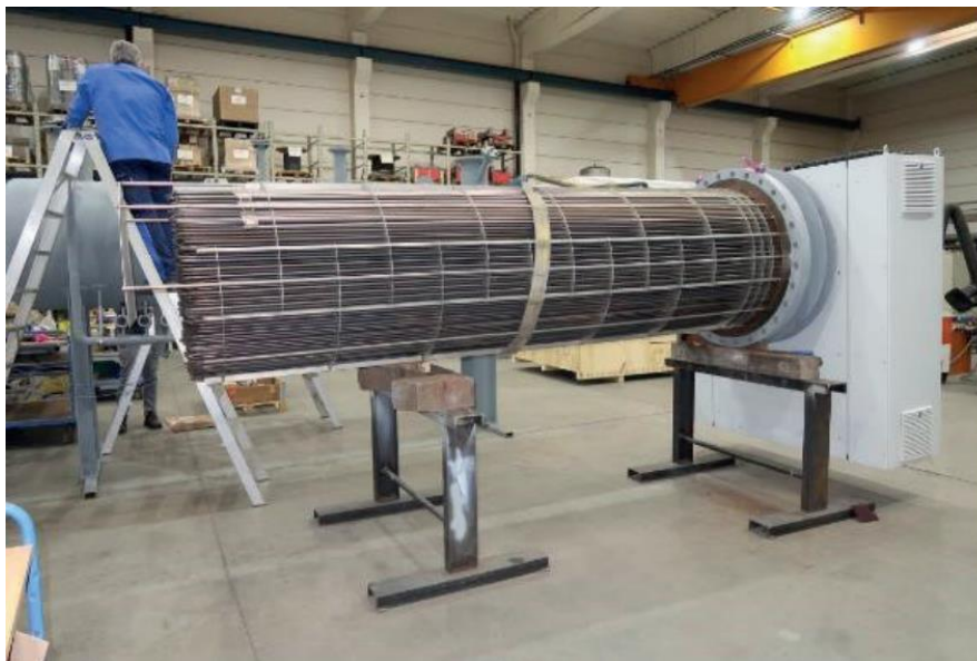
11. ábra Elektromos kazán felépítése Gössendorfban: forrás [11]
