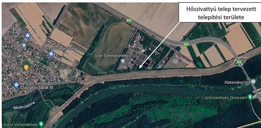
63. ábra Szennyvíztelepen tervezett hőszivattyú telepítési helye
