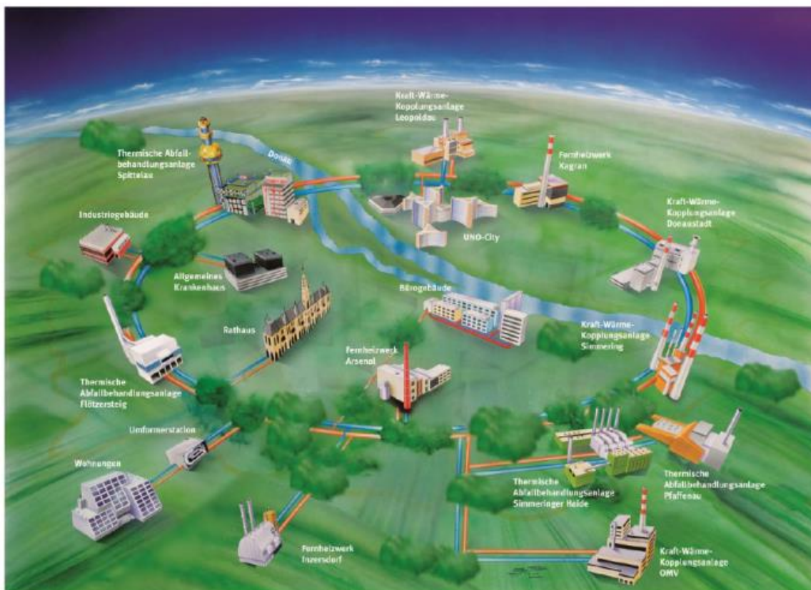
10. ábra Bécsi távhő körgyűrű elvi sémája a kapcsolódó erőművekkel [10]
