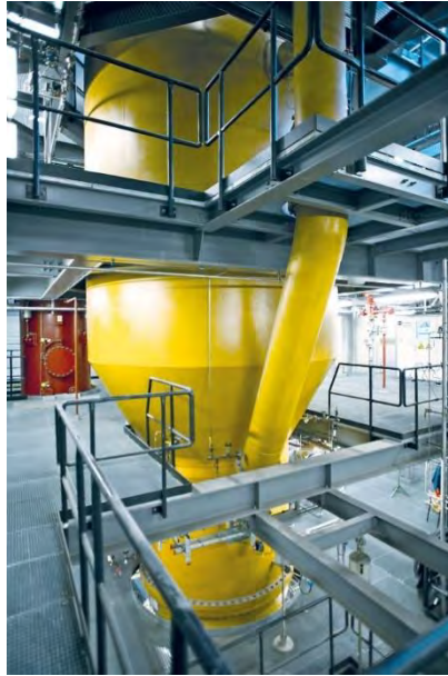
15. ábra Korszerű nyomás alatti biomassza elgázosító Skieveben [13]
