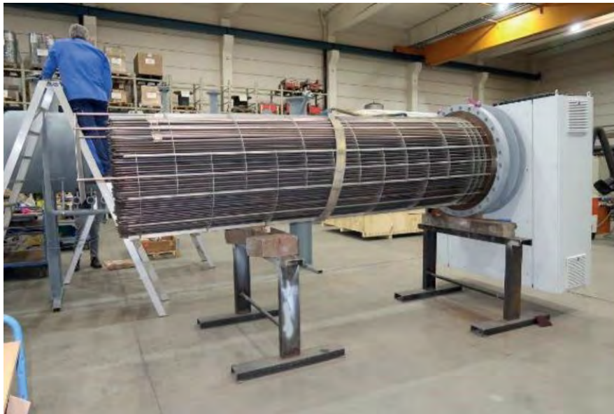
11. ábra Elektromos kazán felépítése Gössendorfban: forrás [11]
