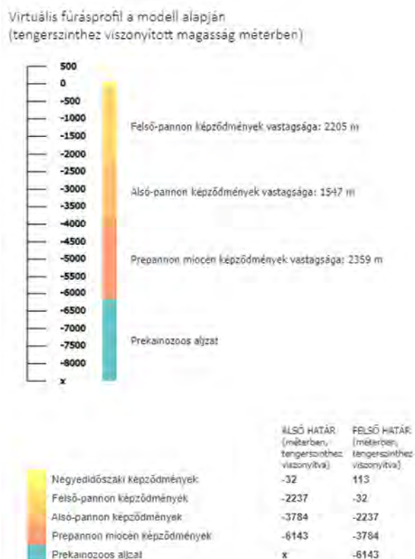
1.1.3. Virtuális fúrásprofil a győri területről (Forrás: MBFSZ, 2024.)
