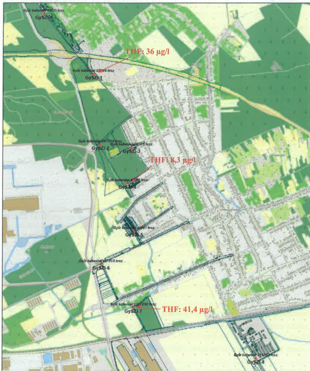
A THF szennyezettséget mutató talajvízfigyelő kutak elhelyezkedése és a mért koncentráció-értékek a 2026. 1. negyedéves vizsgálatokkor
